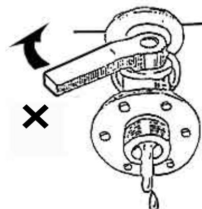
点検・整備時には回転している部分には触れないで下さい。ポンプ又はドライブシャフトなどの回転状況の点検時以外はエンジンを停止して点検・整備を行って下さい。
