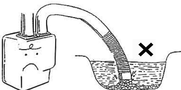
バスケット・ストレーナが水面に出ているとエアを吸い込み、吸い込み不良となります。
