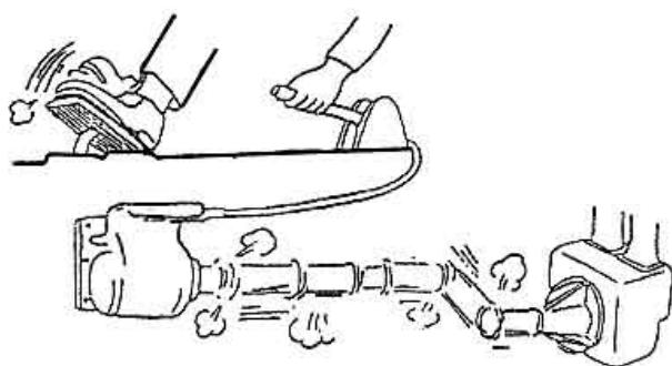
砂、砂利等の固形物は吸入しないで下さい。ポンプおよびコックに噛み込み破損の恐れがあります。
